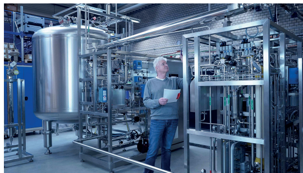
Abbildung 1: Membranbasierte Anlage für GMP-konforme Produktion von WFI (Quelle aller Abbildungen: EnviroFALK).
